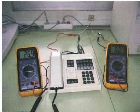
Polímetros midiendo tensión e intensidad en una roseta
